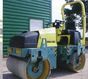
Matériels de compactage (rouleaux, plaques, rammax)
