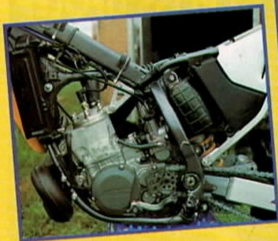
▲ La mécanique a reçu bon nombre d'améliorations. Citons la compression augmentée, l'admission avec reed valve new look, le carbu Keihin de 38 et une fixation "en arrière" de la culasse.
