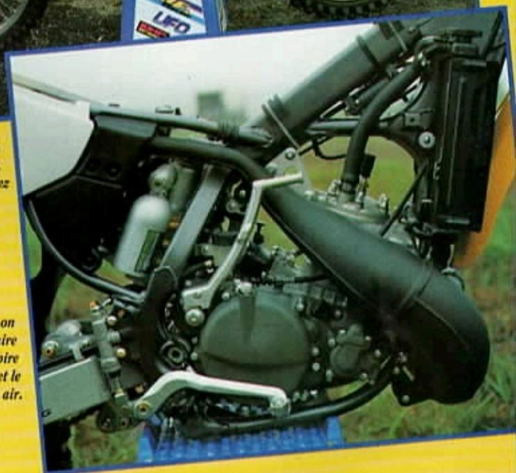
le boîtier de filtre à air de plus grande capacité se démonte en un instant. Il donne accès à l'amortisseur, dont les tarages hydrauliques ont été modifiés. Un revalving total. ▼
